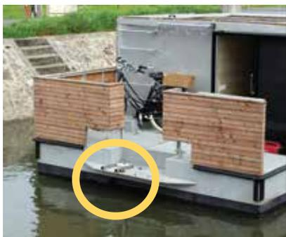
En cas de chute d'homme à l'eau, **UNE ÉCHELLE ENCASTRÉE** est placée à l'arrière du bateau. Elle est accessible et déployable depuis l'eau afin de remonter sur le bateau. L'échelle doit toujours être utilisable et libre d'accès.
