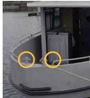
► Le bateau peut être remorqué en utilisant comme points de traction les deux bittes arrière à l'aide d'une patte d'oie. L'angle formé par la patte d'oie doit être inférieur à  $45^\circ$ .
